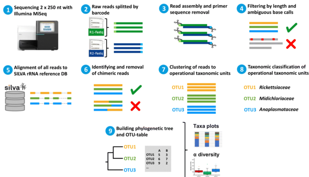
FIGURE 1.3 : Résumé des étapes du séquençage par gène marqueur, tiré de Regier et al. (2019).
